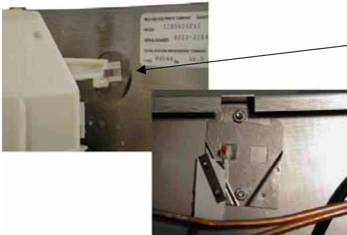
Korrekte Position des Drahtlaschen-Schalterstellglied
