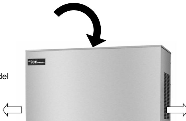
Para enfriar apropiadamente el condensador, debe haber un flujo de aire adecuado alrededor de la máquina. La temperatura del aire ambiente no debe exceder de 100°F (38°C). Vea la Guía de Instalación de la página A6. Debe mantenerse limpio el motor del condensador y las aspas del ventilador. Puede limpiarse el condensador con aire comprimido o usando un cepillo.
